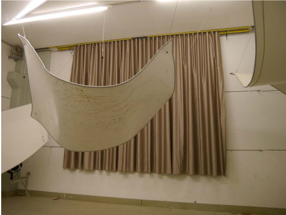
Abbildung C.1. Geraffte Prüfanordnung im Hallraum (frontale Ansicht).
