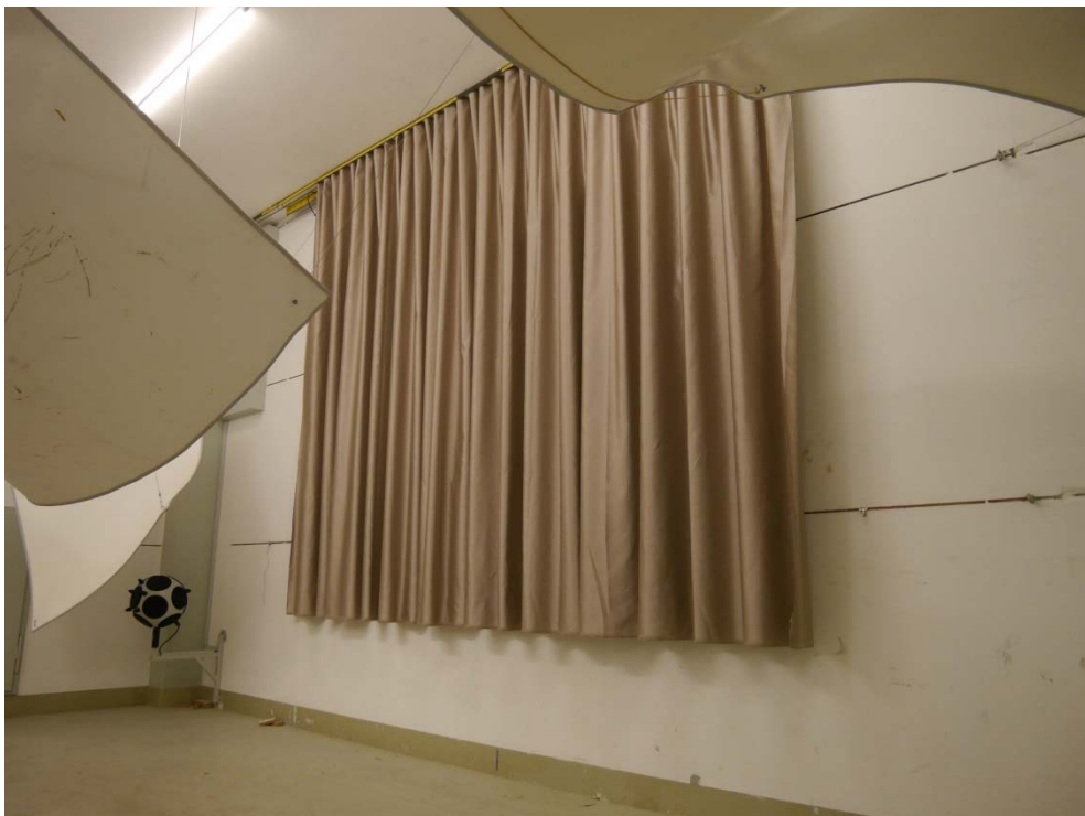
Abbildung C.2. Geraffte Prüfanordnung im Hallraum (Schrägansicht).
